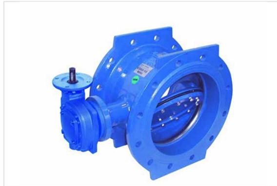
Robinet à papillon BB (bride-bride) avec joint dans le papillon automatique (JPA) à double excentricité et écartement long entre brides.
