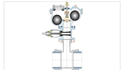
1. Montage direct sur té : le système de fermeture central permet, sans coupure d'eau du secteur, l'entretien régulier de la Ventex notamment changement du flotteur côté tuyère
