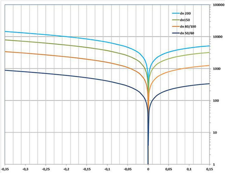
Débit d'air évacué par le gros orifice en m3/h (à la pression de la canalisation : débit d'air = débit d'eau) - Débit d'air admis par le gros orifice en m3/h (à la pression de la canalisation : débit d'air = débit d'eau);
